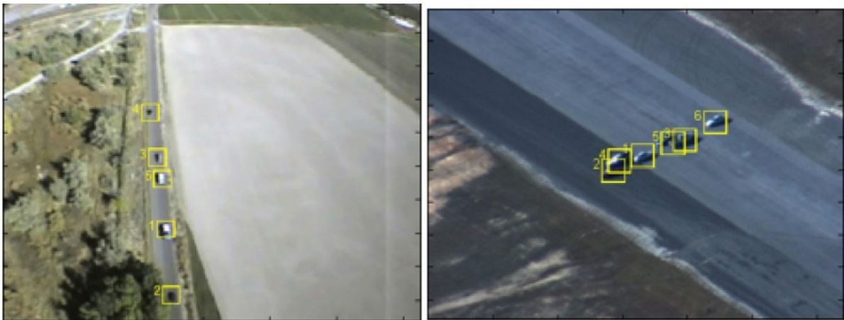
รูปที่ 2 การใช้กล้อง UAV ติดตาม (Tracking) เป้าหมายภาคพื้น (ที่มา : icb.ucsb.edu)
