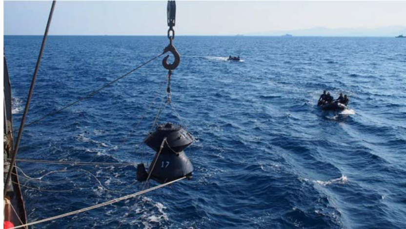
รูปภาพ การฝึกวางและทดสอบกลไกการทำงานโดยอัตโนมัติ ของทุ่นระเบิดทอดประจำที่ปราบเรือดำน้ำแบบล่องหน (กองเรือทุ่นระเบิด)
