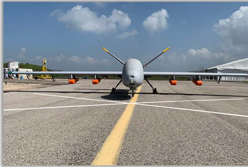
ตัวอย่างรูปภาพ อากาศยานไร้คนขับ Hermes 900 พร้อมด้วยแพชูชีพที่ไต้ปีก 4 ชุด (Elbit Systems)
