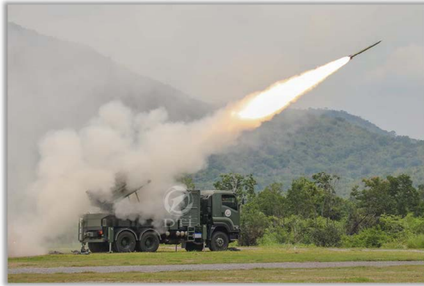
รูปภาพ การทดสอบยิงจรวด DTI-2 ขนาด 122 มม. (@dtithailand)
