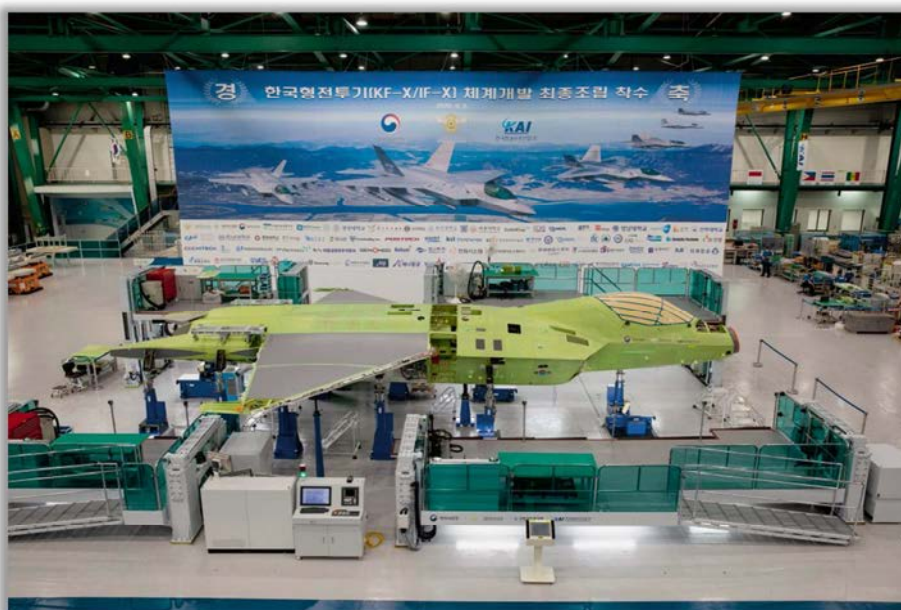
รูปภาพ การประกอบรวมขั้นสุดท้ายของเครื่องบินขับไล่ KF-X ณ โรงงานอากาศยาน Sacheon (DAPA)
