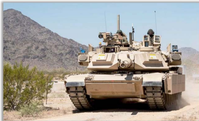
ตัวอย่างรูปภาพ รถถังหลัก Abram ของกองทัพสหรัฐอเมริกาที่ติดตั้งระบบ Trophy APS (Rafael)
