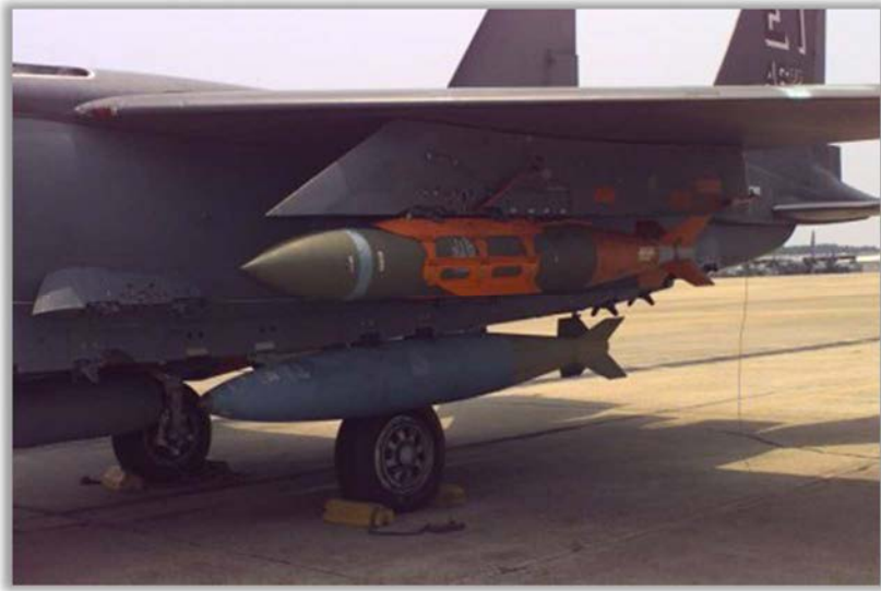
ตัวอย่างรูปภาพ ลูกระเบิด BLU-109/B (Earth-Penetrating) (ที่มาของภาพ : Wikipedia)
