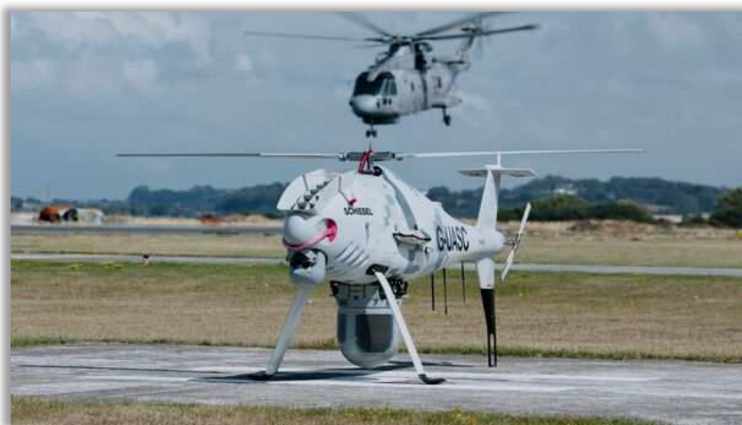
รูปภาพ อากาศยานไร้คนขับ Camcopter S-100 ที่ติดตั้งเรดาร์ I-Master (ที่มาของภาพ: Thales)
